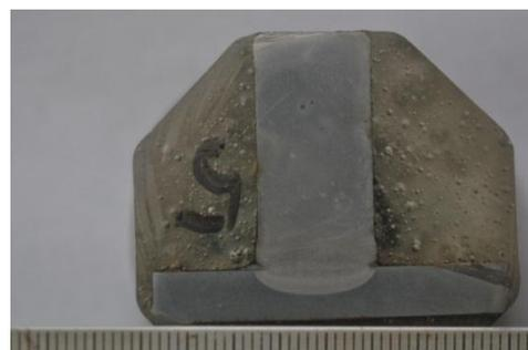
**Gambar 4.11 Hasil uji metalografi makro Spesimen #5**
