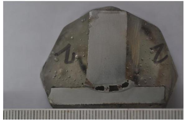
**Gambar 4.8 Hasil uji metalografi makro Spesimen #2**
