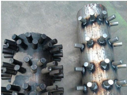
**Gambar 4.6 Hasil pengelasan Stud Welding, Metoda Semiotomatis (kiri), dan Metoda Manual (kanan)**
